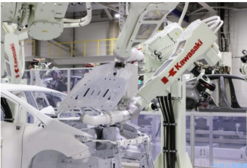
川崎重工業的工業用機器人利用於汽車塗裝工程
