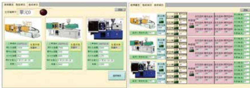
圖7 產線設備能耗監視軟體畫面
