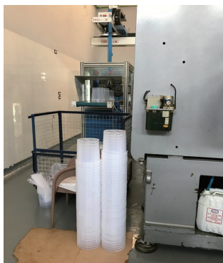
Japanese Molding 新的半自動化生產線，來自韓國與台灣的塑膠射出機，生產各種大小塑膠包裝容器
