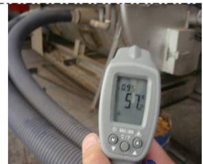
鍋爐壁溫度量測
