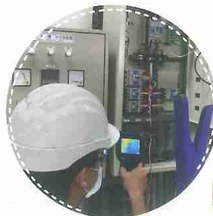
電力盤熱點量測
